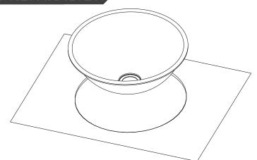
• ESTE LAVABO ES DE SOBREPONER, Y SE REQUIERE DE UNA PERFORACIÓN DE 33.5 CM⊅ EN CUBIERTA PARA SU CORRECTA COLOCACIÓN.
