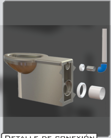
DETALLE DE CONEXIÓN
